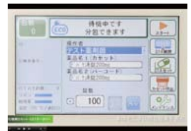
カセットのRFIDと薬品のGS1データバーでダブルチェック
