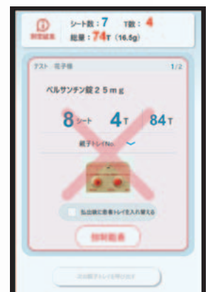
重量鑑査を行い、ピッキング詳細モニターに大きな「O」、「X」を表示します。重量が合っている場合は「O」表示になります。
