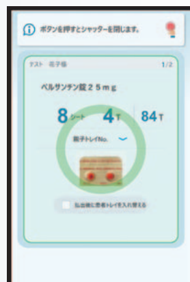
重量鑑査を行い、ピッキング詳細モニターに大きな「O」、「X」を表示します。重量が合っている場合は「O」表示になります。
